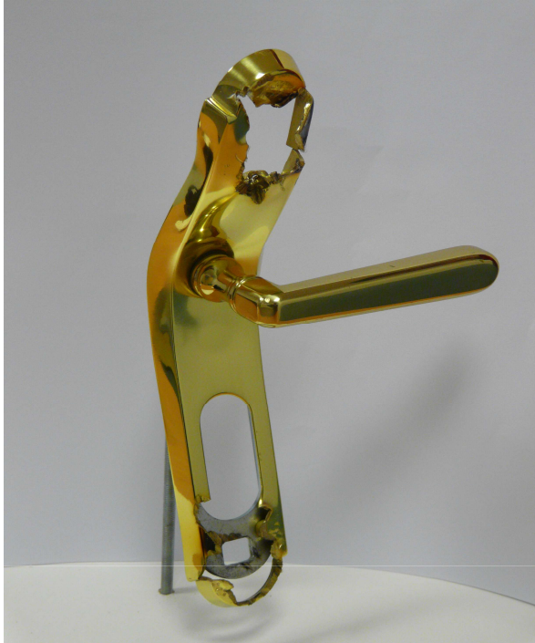
Obr.č.1 Celkový pohled na zničený štítek bezpečnostního kování
